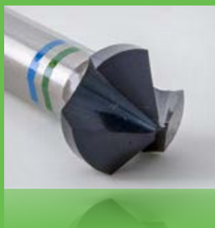
Változó hátcsiszolási geometria
