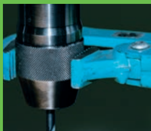
Minimális erőfeszítéssel nyitható és zárható fúrótokmány
